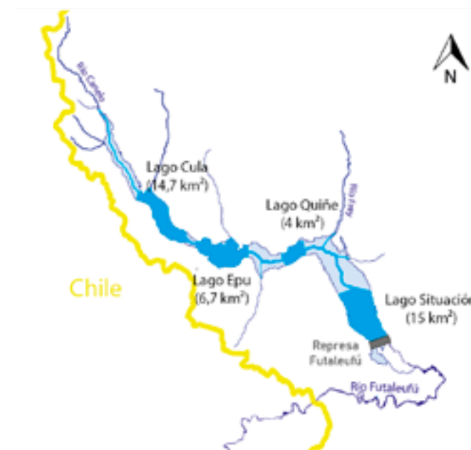
Figura 6: Esquema de la inundación de cuatro lagos y de los ríos que los interconectaban para instalar el embalse Amutui Quimey y la central hidroeléctrica Futaleufú (ilustración aproximada).
